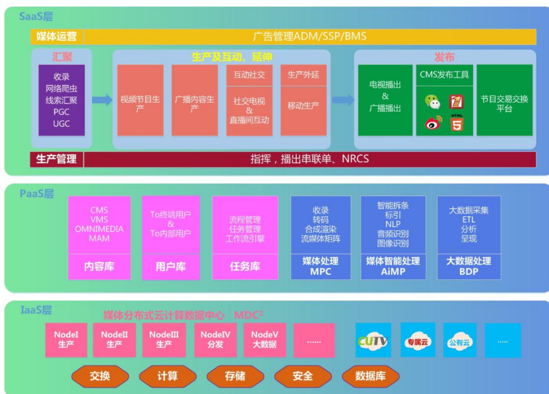
图 44 面向媒体融合发展的媒体云平台业务框架示意图
