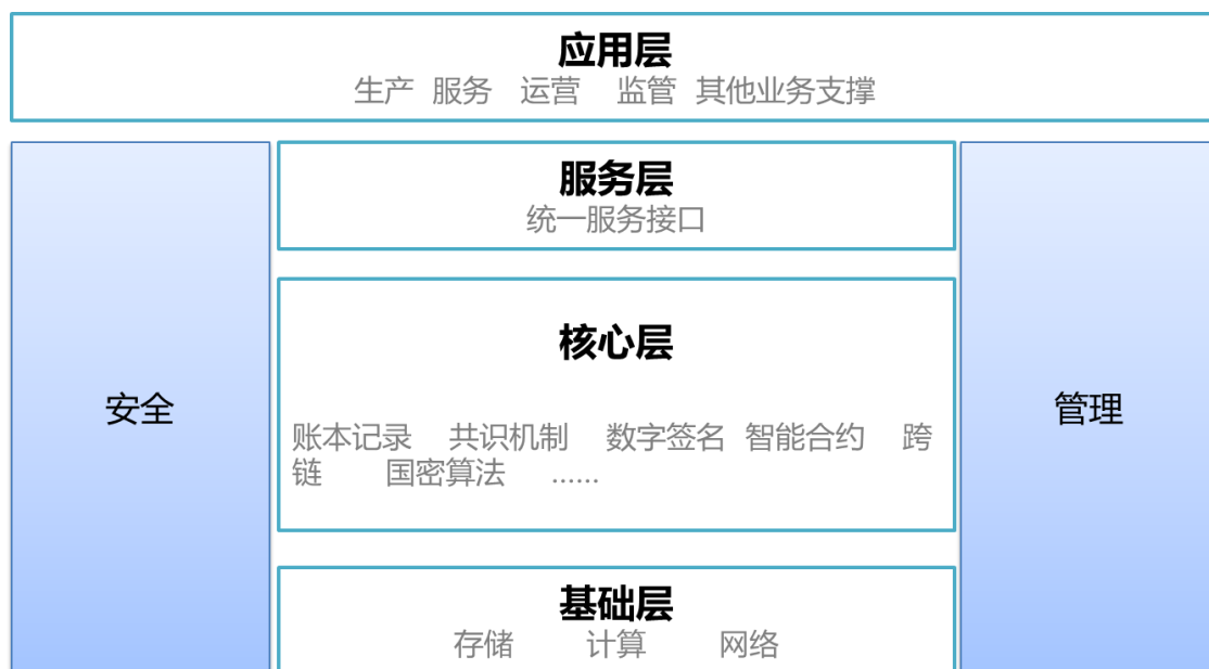
图 3-3 融媒体区块链系统架构
