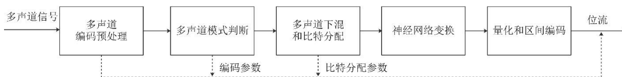
图E.5 通用码率音频多声道编码器
