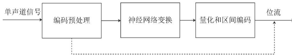
图E.2 通用码率音频单声道编码器
