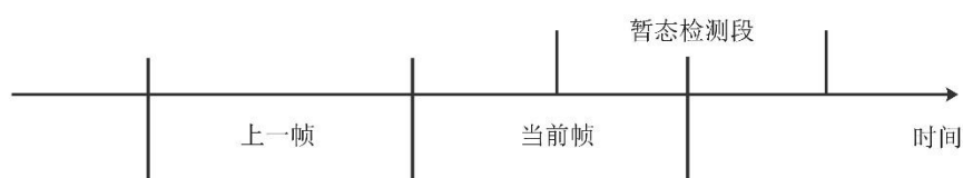
图E.8 暂态检测算法信号分帧示意图
