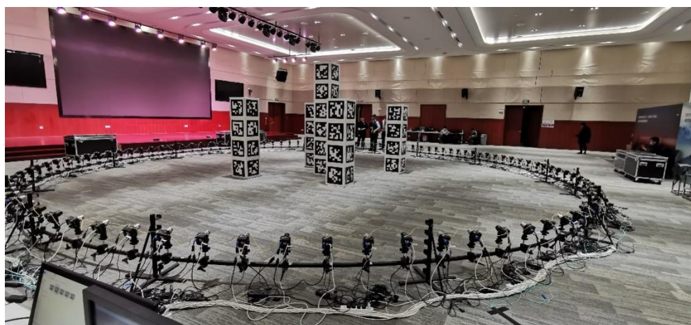
图A.2 某大型晚会节目自由视角系统部署图
