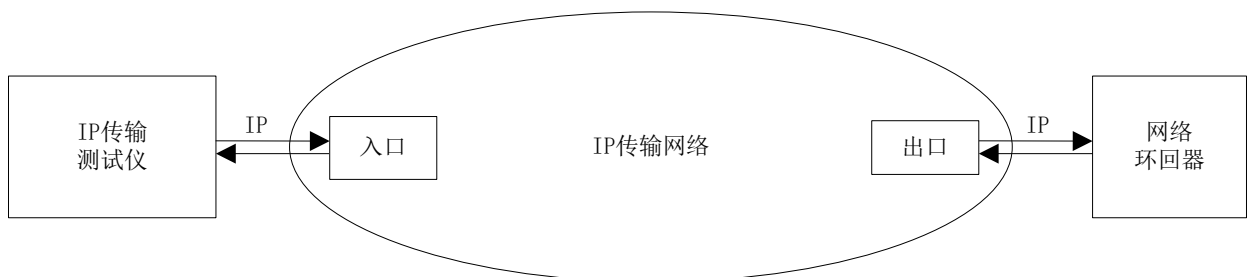
图3 IP传输网络性能简化测量框图
