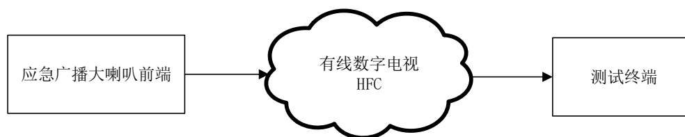
图21 有线数字电视接入测量框图
