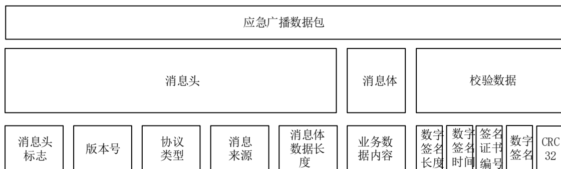
图 A.1 应急广播平台与大喇叭前端适配器通讯数据包格式
