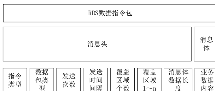
图 A.3 RDS 方案中的特殊指令封装结构
